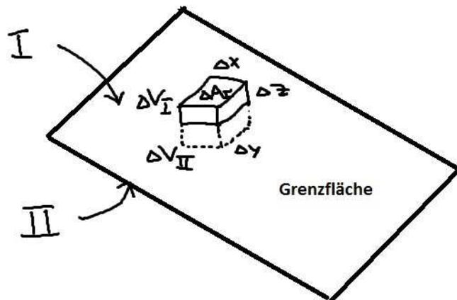
Abbildung 1.13: Infinitesimales Volumenelement an der Grenzfläche.
