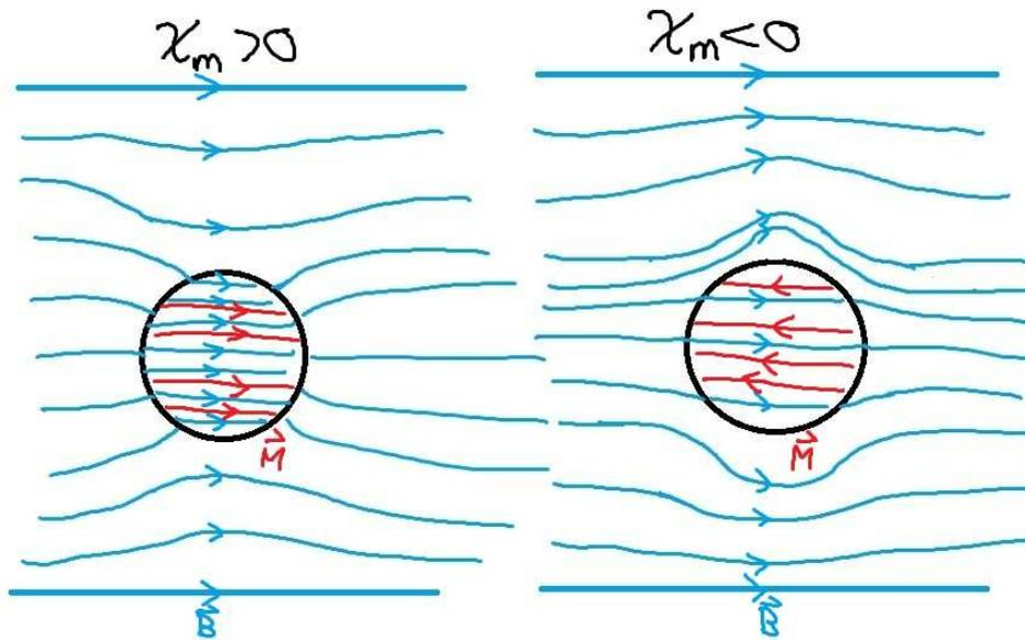
Abbildung 2.11:  $\vec{B}$ -Felder und Magnetisierung  $\vec{M}$  für zwei Kugeln unterschiedlicher mg. Suszeptibilität.
