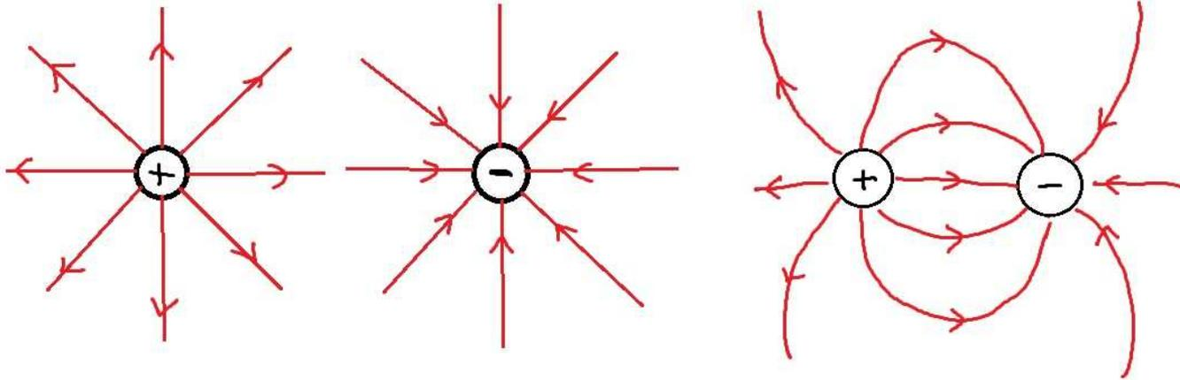
Abbildung 1.5: Feldlinien einer positiven, einer negativen und Superposition einer positiven und einer negativen Punktladung.
