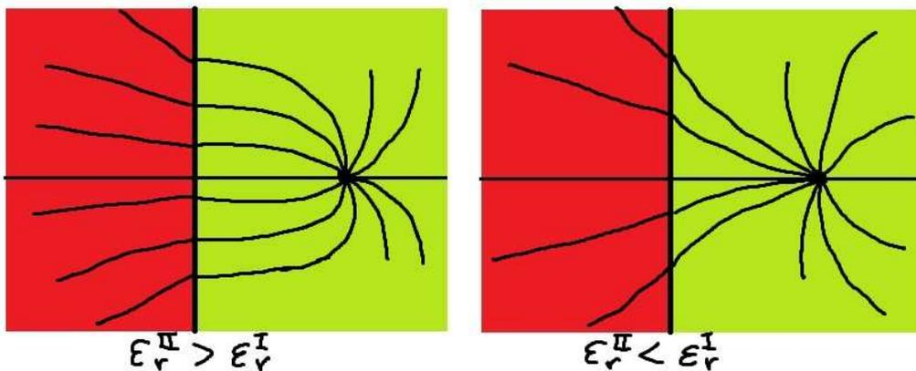
Abbildung 1.29: Qualitative Darstellung der Feldlinien des  $\vec{E}$ -Feldes einer Punktladung in einem von zwei Halbräumen unterschiedlicher Polarisierbarkeit. Der linke Fall ( $\epsilon_r^{II} > \epsilon_r^I$ ) entspricht für  $\epsilon_r^{II} \rightarrow \infty$  dem der Punktladung über einer Leiterplatte!
