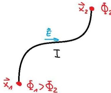
Abbildung 2.3: Vom Ort  $\vec{x}_1$  mit Potential  $\phi_1$  zum Ort  $\vec{x}_2$  fließt ein Strom  $I$ , hervorgerufen durch das elektrische Feld  $\vec{E}$ .
