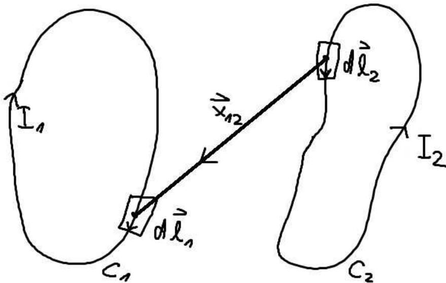
Abbildung 2.4: Zwei Leiterschleifen in denen die Ströme  $I_1$  bzw.  $I_2$  fließen.
