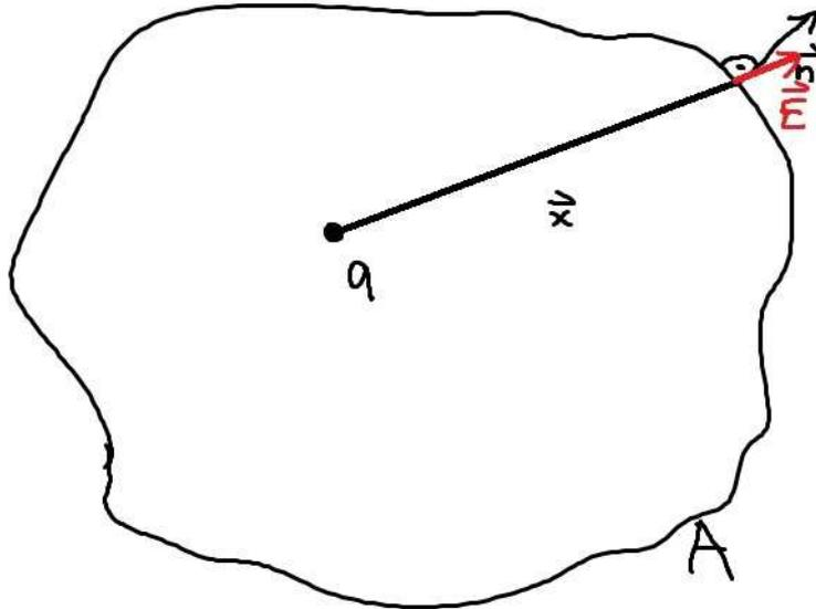
Abbildung 1.11: Die Fläche  $A$  umschließt die Punktladung  $q$ .
