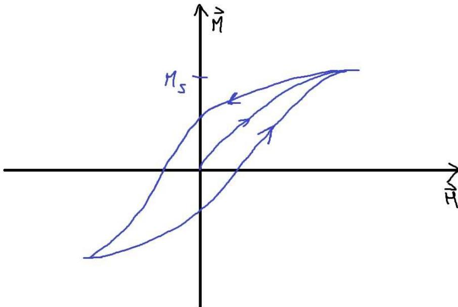
Abbildung 2.10: Typische Hysteresekurve von Ferromagnetika. Der Startwert bei  $(0, 0)$  gilt nur bei vollständiger Entmagnetisierung (z.B. durch Erwärmung), d.h. mikroskopischer Unordnung. Die Magnetisierungskurve weist eine starke Nicht-Linearität auf.
