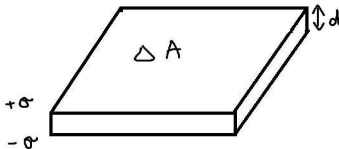
Abbildung 1.15:  $\mathcal{D} \cdot \Delta A =$  Dipolstärke der Fläche  $A$ , mit Dipolflächendichte  $\mathcal{D}$ .
