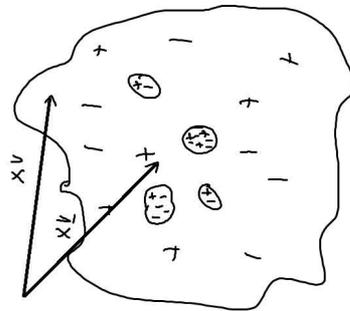
Abbildung 1.26: Einzelne mikroskopische Ladungsverbände  $j$  (Atome, Cluster, Moleküle, ...) bei  $\vec{x}_j$  erzeugen „mikroskopisches Feld“. Das Fernfeld eines Verbandes ist charakterisiert durch die Ladung  $q_j$  und das Dipolmoment  $\vec{p}_j$ .
