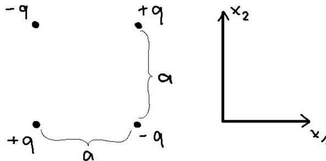
Abbildung 1.22: Illustration zu Beispiel Nr. 3: Vier Punktladungen, angeordnet als Quadrat in der  $x_1$ - $x_2$ -Ebene mit Kantenlänge  $a$ .
