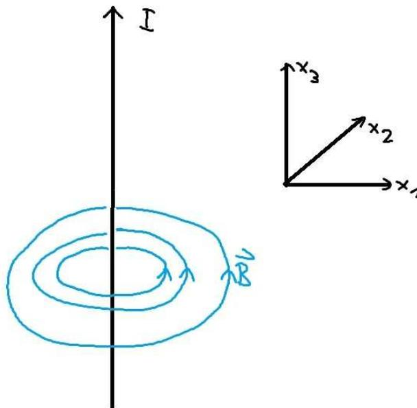
Abbildung 2.5:  $B$ -Feld eines linearen Stromfadens
