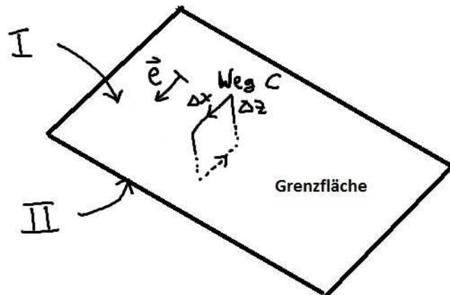
Abbildung 1.14: Infinitesimaler, geschlossener Weg an Grenzfläche,  $\vec{e}_\perp \perp \vec{n}$ .
