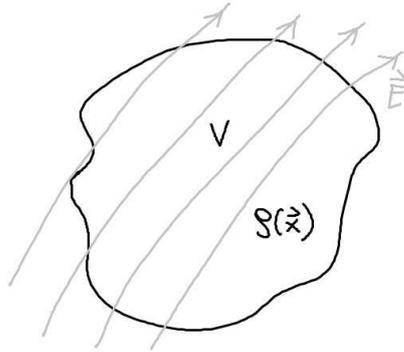
Abbildung 1.24: Ladungsverteilung im Volumen  $V$ , welches von einem externen  $\vec{E}$ -Feld durchsetzt wird.
