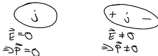
Abbildung 1.27: Verschiebungspolarisation in mikroskopischen Ladungsverbänden
