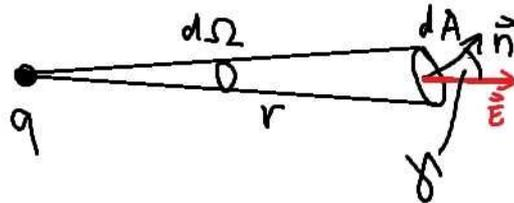
Abbildung 1.12: Flächennormale  $\vec{n}$  und  $\vec{E}$  schließen den Winkel  $\gamma$  ein.
