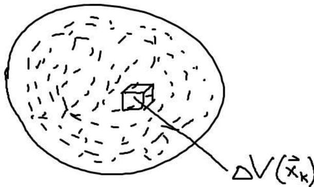
Abbildung 1.2:  $\Delta V(\vec{x}_k)$  stellt ein kleines Volumen am Ort  $\vec{x}_k$  dar mit  $\Delta q(\vec{x}_k) = \sum_{n \in \Delta V(\vec{x}_k)} q_n$
