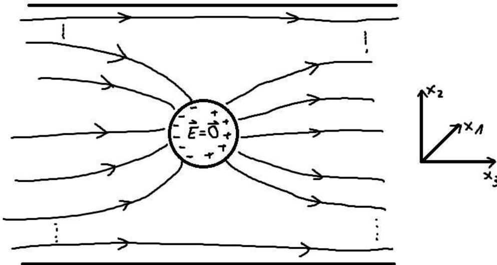
Abbildung 1.20: Die  $x_3$ -Achse wird auf Grund der Symmetrie des Problems in Richtung des äußeren Feldes gelegt.
