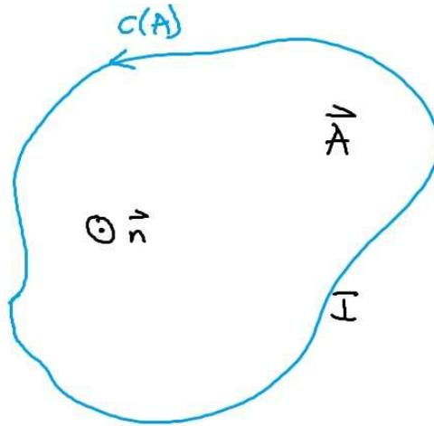
Abbildung 2.7: Ebener Stromfaden der eine Fläche  $A$  umschließt
